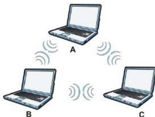
Иллюстрация 153 Соединение Peer-to-Peer Communication в сети Ad-hoc
